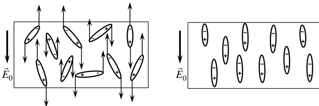
б) В случае неполярных диэлектриков в электрическом поле произойдет деформация распределения зарядов. Отрицательные заряды – электроны сместятся против поля, а положительные – сместятся по полю, хотя значительно меньше, поскольку более тяжелые. Это явление называется **электронной (деформационной) поляризацией** диэлектриков.
