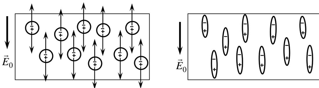
в) В случае ионных диэлектриков произойдет смещение положительных ионов кристаллической решетки (по полю) и отрицательных ионов (против поля) – **ионная поляризация**.
