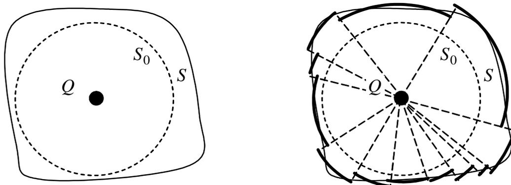
Суммарный поток через эти участки, с одной стороны, будет равен потоку через поверхность  $S$ . С другой стороны, он будет равен суммарному потоку через участки, которые в совокупности образуют сферу  $S_0$ . Таким образом, поток через произвольную замкнутую поверхность  $S$  будет равен потоку через сферу  $S_0$ , в центре которой расположен создающий поле заряд. Поток через такую сферу мы нашли, следовательно, поток через произвольную замкнутую поверхность будет равен
