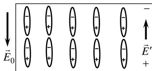
Величина напряженности собственного поля диэлектрика пропорциональна суммарной напряженности  $E' = \chi E$ , коэффициент пропорциональности  $\chi$ , который зависит от свойств диэлектрика, называют **диэлектрической восприимчивостью вещества**.
