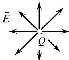
Для изображения электрического поля используют **силовые линии**. Это линии, касательные к которым совпадают по направлению с вектором напряженности  $\vec{E}$ , и их плотность (густота) пропорциональна величине напряженности поля.
