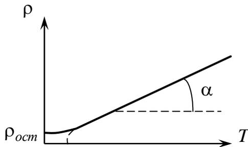
при абсолютном нуле. Это связано с наличием примеси (чужеродных атомов) в кристаллической решетке металла и ее неидеальностью (наличием дефектов кристаллической структуры).
