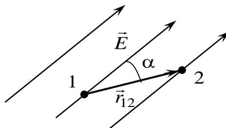
вектор, соединяющий точку 1 с точкой 2,  $d = |\vec{r}_{12}|$ ,  $\alpha$  – угол между  $\vec{E}$  и  $\vec{r}_{12}$ . Если  $\vec{r}_{12} \uparrow\uparrow \vec{E}$ , то мы получим выражение, определяющее разность потенциалов в однородном поле вдоль силовой линии между точками на расстоянии  $d$  друг от друга
