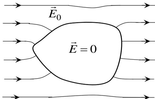
Поскольку внутри проводника поля нет,  $\vec{E} = 0$ , то потенциал проводника постоянен, и поверхность металла является эквипотенциальной поверхностью. Следовательно, при внесении проводника во внешнее поле, оно будет искажаться, поскольку напряженность поля вблизи поверхности металла становится перпендикулярной поверхности.
