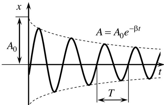
Колебательный процесс будет происходить при не слишком сильном (докритическом) затухании ( $\beta < \omega_0$ ). В этом случае общее решение уравнения имеет вид **затухающих колебаний**
