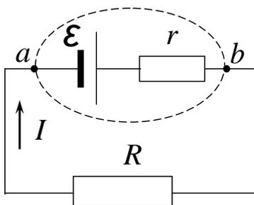
Рассмотрим *замкнутую цепь*, содержащую источник ЭДС с внутренним сопротивлением  $r$  и подключенную к источнику нагрузку сопротивлением  $R$ .
