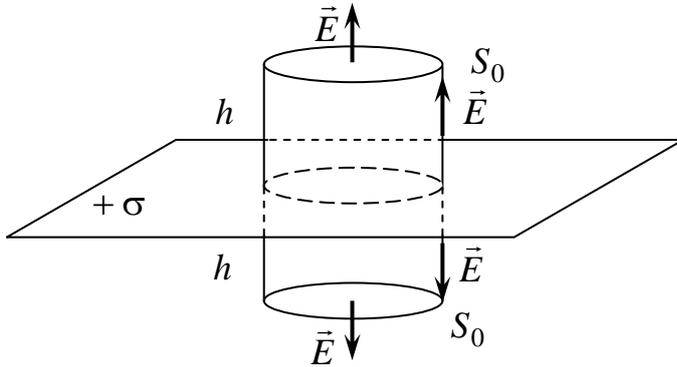
В качестве гауссовой поверхности выберем цилиндр с направляющими, перпендикулярными заряженной плоскости, площадью оснований  $S_0$ , отстоящих от плоскости на расстоянии  $h$ . Найдем поток вектора напряженности через поверхность цилиндра, который будет равен сумме потоков через основания и боковую поверхность
