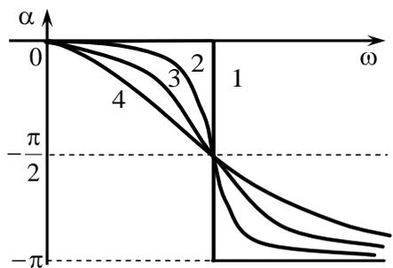
Зависимость  $\alpha(\omega)$  называется **фазово-частотной характеристикой (ФЧХ)**, и она имеет вид
