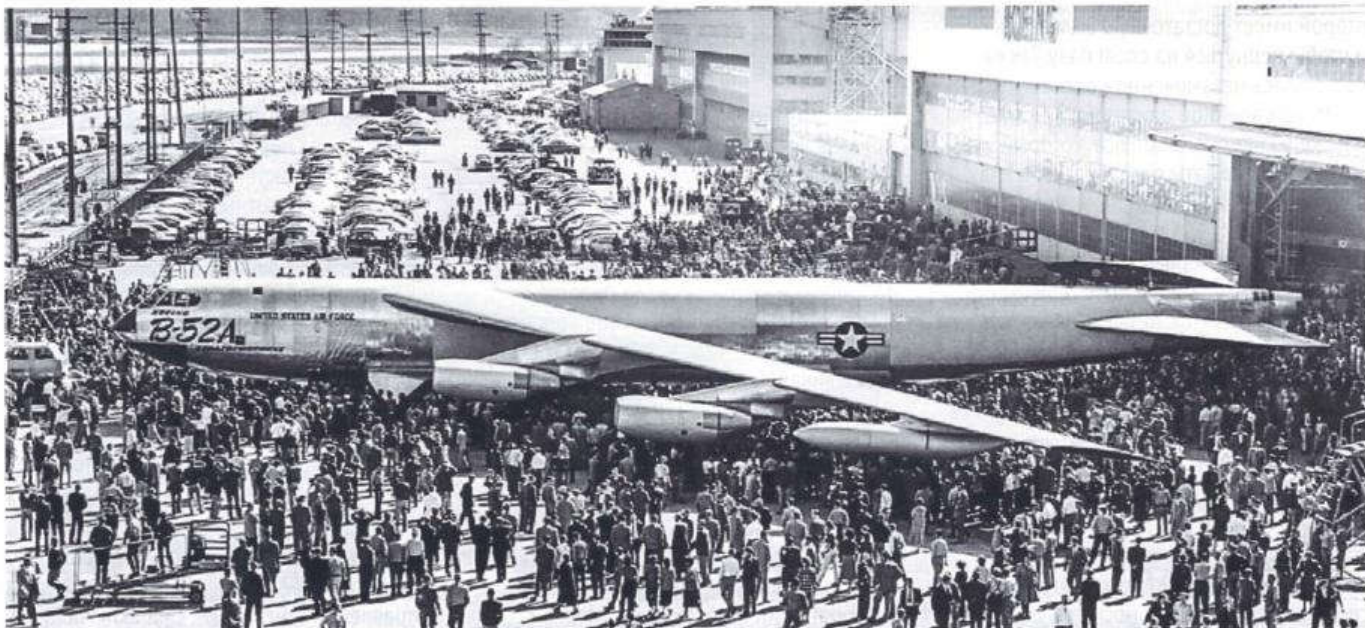
Выкатка первого В-52А №52-001 на заводе в Сизтле 18 марта 1954 г. Киль сложен, так как в то время в ворота цеха он не проходил
