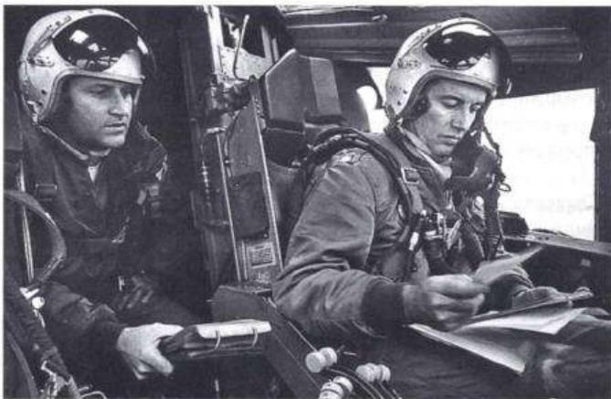
Первый пилот на катапультируемом вверх кресле и проверяющий на откидном сиденье за ним в кабине В-52 первых модификаций
