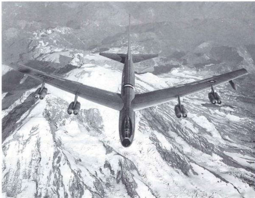
YB-52 в испытательном полете с подвесными топливными баками
