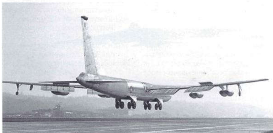
Самолет 49-230 заходит на посадку – выпущены закрылки и интерцепторы, находящиеся между секциями закрылков, элероны-демпферы в нейтральном положении
