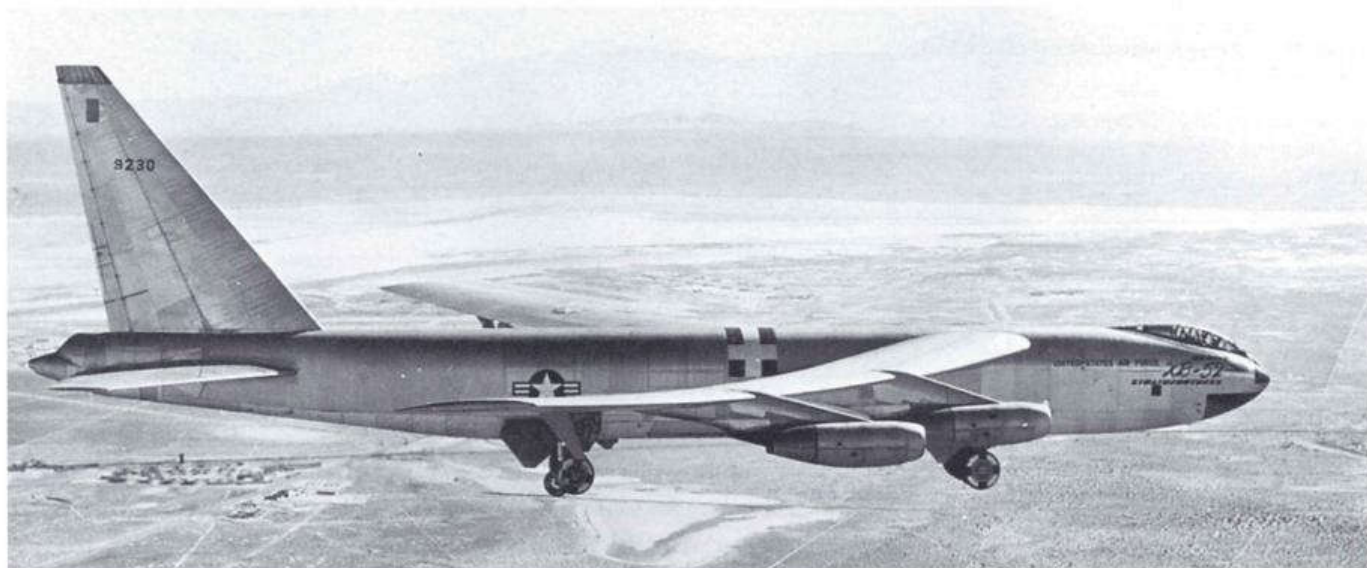
Опытный самолет XB-52-BO S/N 49-230 в полете. На фото видно, как изгибаются дугой гибкие консоли крыла даже при небольших нагрузках
