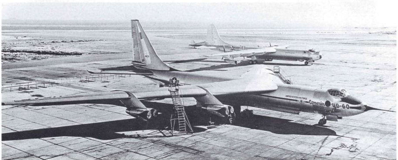
Конкурент В-52 – реактивный Конвер YB-60 должен был быть дешевой модификацией поршневого В-36 (на заднем плане), но сохранил лишь 28% общих с ним узлов и вырос в цене «до небес»
