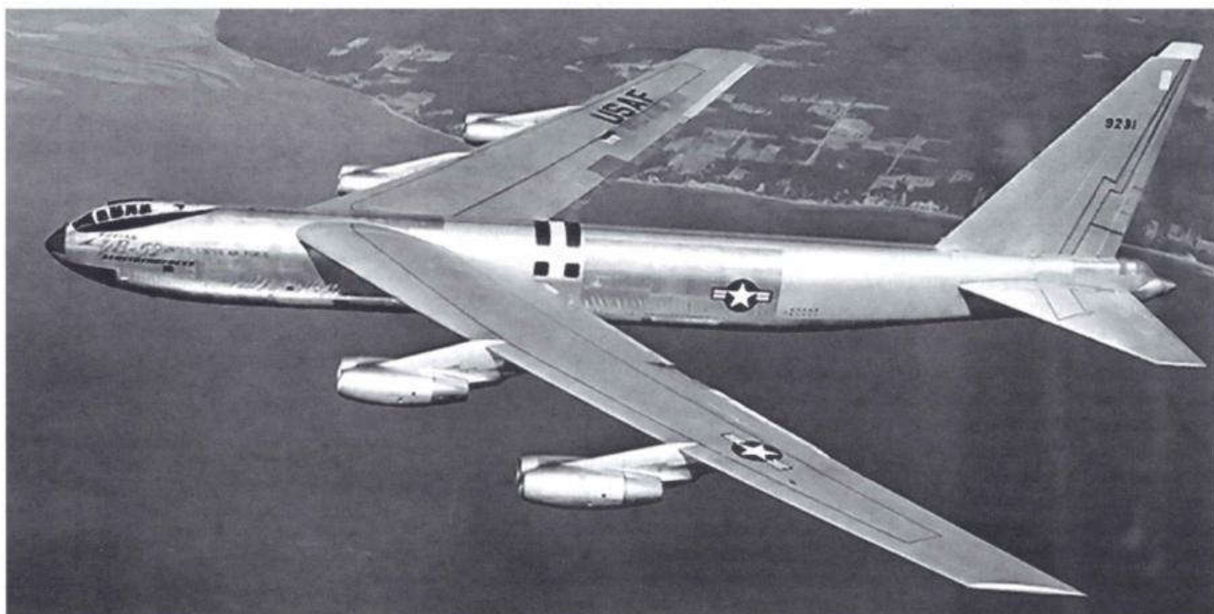
Опытный YB-52 (рег. № ВВС 49-231) в испытательном полете. На фюзеляже нанесена метка для кинографирования. В отличие от первого прототипа XB-52, на этой машине хорошо видна деформация обшивки фюзеляжа
