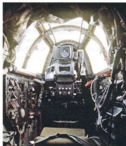
Кабина хвостового стрелка: вверху круглый индикатор РЛС обнаружения целей, под ним прямоугольный экран радиоприцела, левее – индикатор прицела телевизионного
